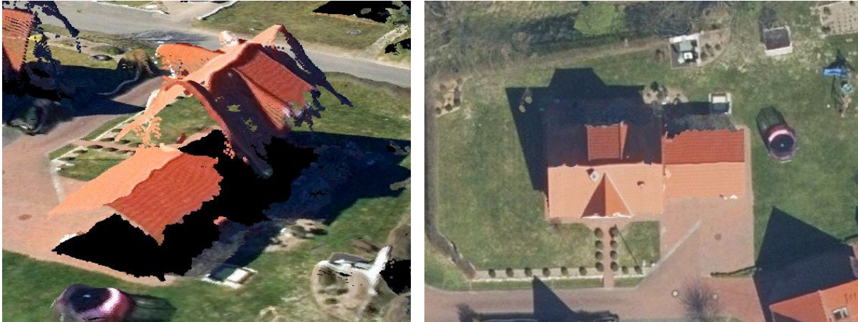
Abbildung 8: Artefakte an Dachkanten im bildbasierten Digitalen Oberflächenmodell (bDOM, links) und Digitalen Orthophoto (TrueDOP, rechts). DOP 2020, Qualitätsstufe TrueDOP, Geobasis NRW
