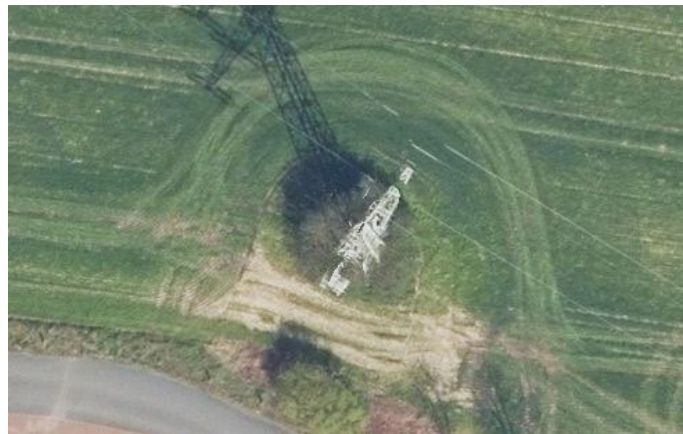
Abbildung 4: Artefakte bei Objekten, deren Struktur im Bereich der geometrischen Auflösung der Luftbilder liegt, Bsp.: Hochspannungsleitung. DOP 2020, Qualitätsstufe TrueDOP, Geobasis NRW
