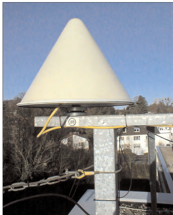
Abb. 11b: Trimble-Choke-Ring-Antenne (TRM29659.00 TCWD) hier mit Radom (Foto: Galitzki)
