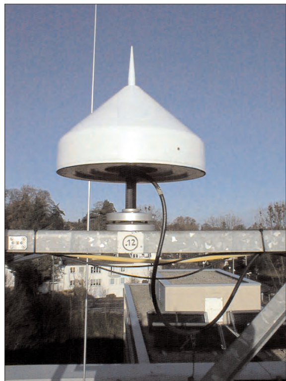
Abb. 10b: Spectra-Precision-Choke-Ring-Antenne (SPP571908273 SPKE), hier mit Radom (Foto: Galitzki)
