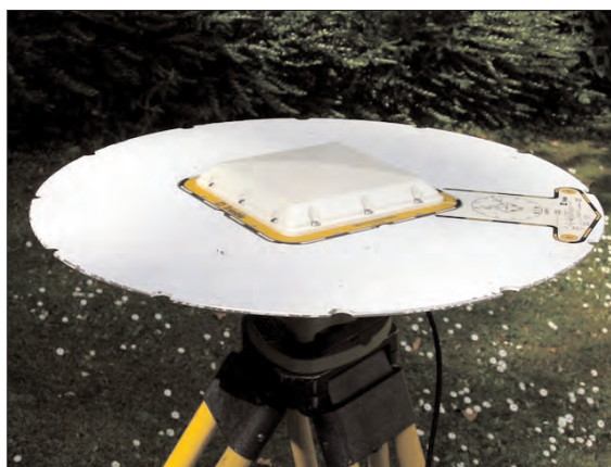
Abb. 16: Trimble-Microcentered-Antenne (TRM33429.00+GP) mit Grundplatte (Foto: Galitzki)
