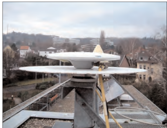
Abb. 14 Trimble-Zephyr-Geodetic-Antenne (TRM29659.00) mit Grundplatte auf Dreifuß (Foto: Galitzki)
