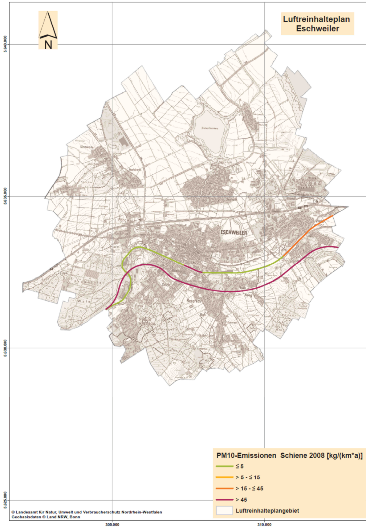
Abb. 3.2/8 PM 10 -Emissionen des Schienenverkehrs im Untersuchungsgebiet Eschweiler (2008)
