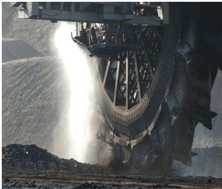
Abb. 5.3/8: Entwicklung, Einbau und Test einer optimierten Hochdruckbedüsung
