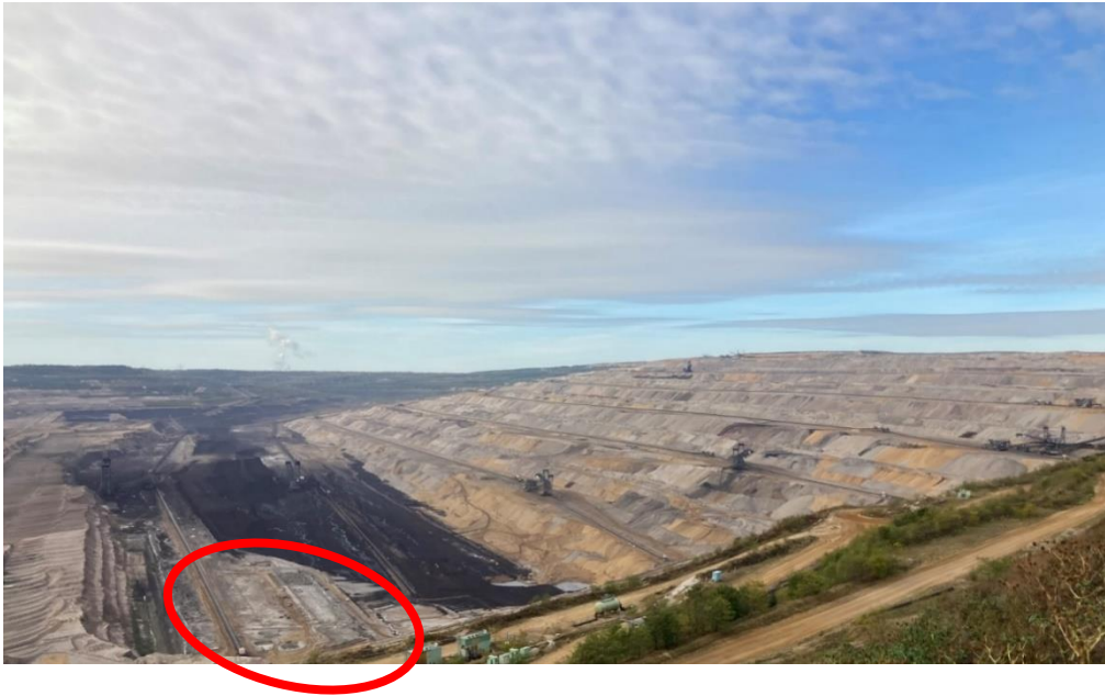
Abb. 43: Einschwenken der Abbaufont vor der Nordrandböschung. Die abknickenden Strossen sind zu erkennen (Quelle: ZAI, 27.10.2021).
