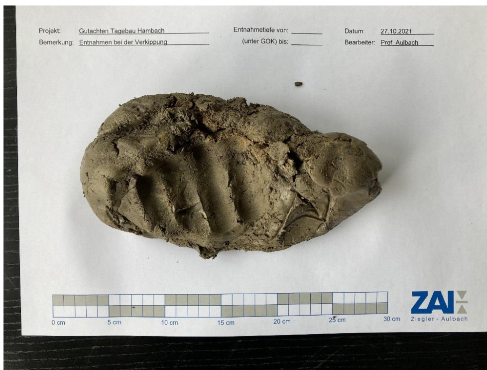
Abb. 22: M2-Material Verkippungsseite, eindrückbar mit der Faust (Quelle: Eigene Aufnahme ZAI)
