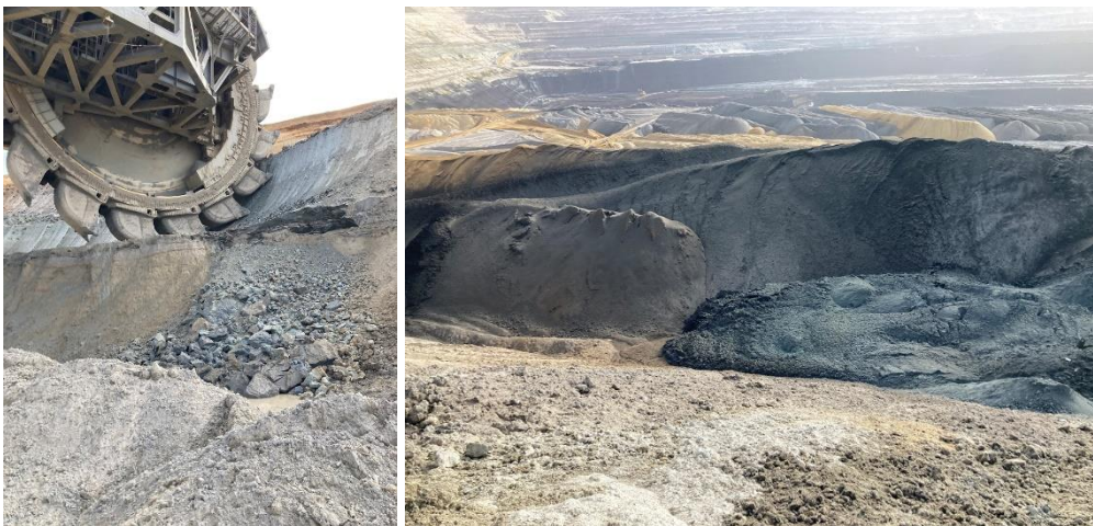
Abb. 19: M2-Material an der Gewinnungsseite links und nach der Verkippung rechts (Quelle: Eigene Aufnahme ZAI)
